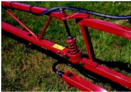
Detalle de una de las 5 secciones independientes de la barra de pulverización
