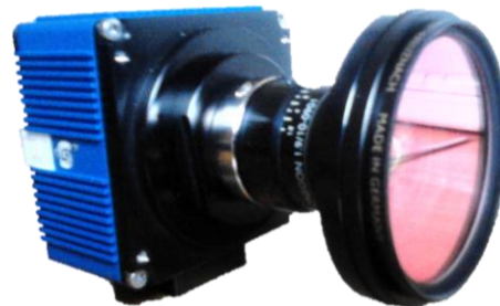
Sistema óptico manual y cámara que permite el ajuste del tiempo de exposición
